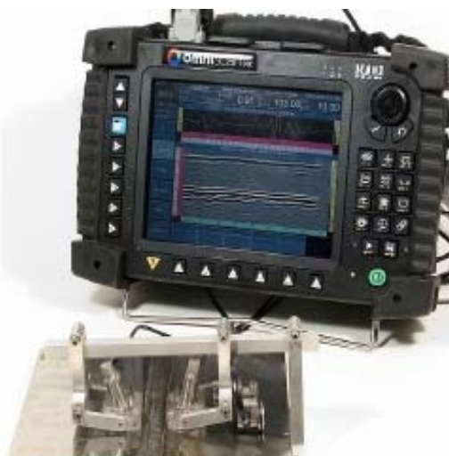
Obr.10 P enosný p ístroj Omniscan s ru ní m skenerem pro kontrolu svaru metodikou TOFD
