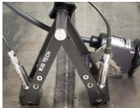
Obr.12 Detail ru ního skeneru pro kontrolu svaru metodikou TOFD
