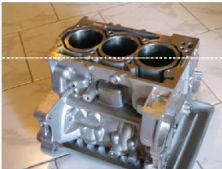
Obr.1 Blok válc s osazenými vložkami.
