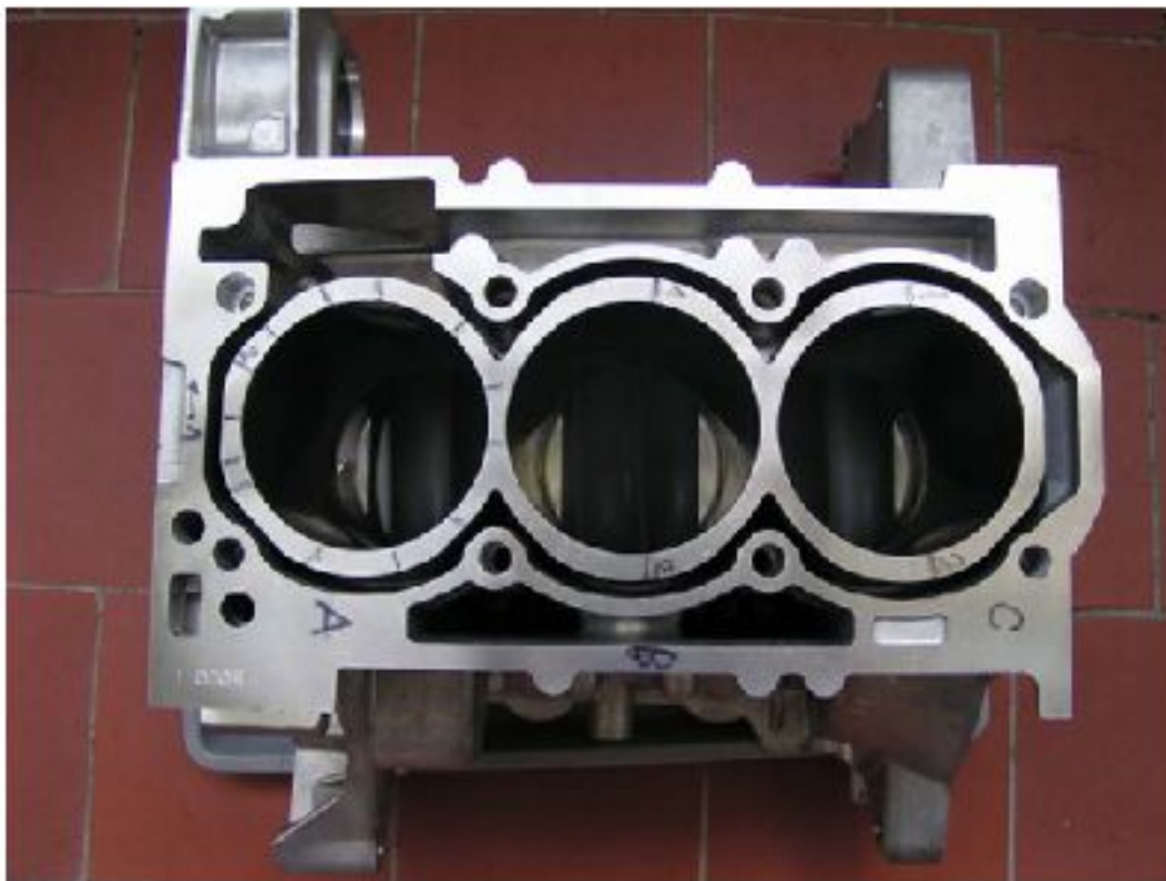
Obr.3 Označení míst, ze kterých byly nasnímány B -scany.
