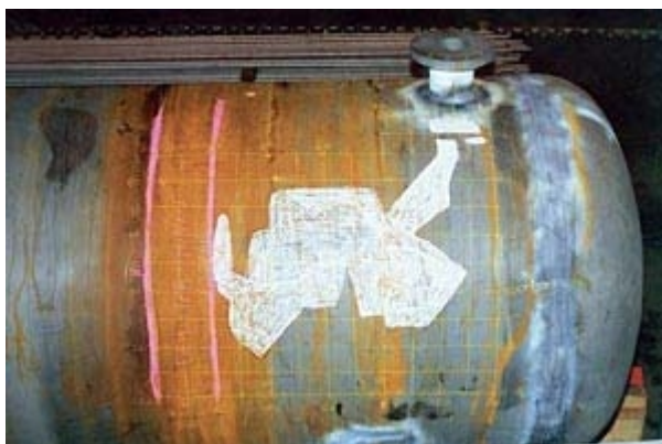
Obr. 20 – Schéma měření a mapování koroze dna nádrže v petrochemickém průmyslu.
