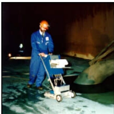
Obr.17 - Měření na dně nádrže
