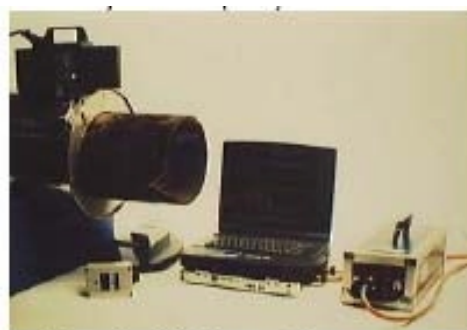
Obr.7 - Zařízení INCOTEST RTD.
