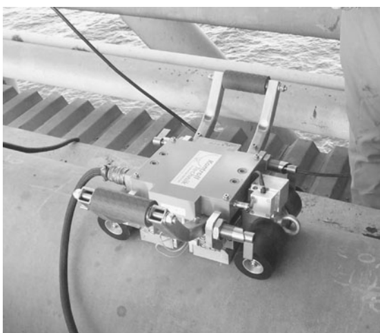
Obr. 16 – Měření tloušky na potrubí – měřící vozík.
