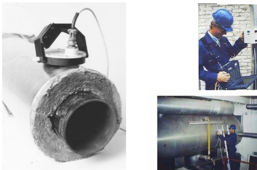
Obr.5 – Příklady měření pomocí pulsních vířivých proudů.
