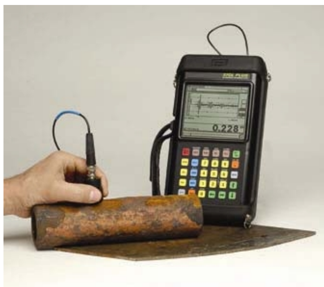
Obr.3 - Měření pomocí sondy EMAT a tloušťkoměr 37 DL Plus společnosti Panametrics
