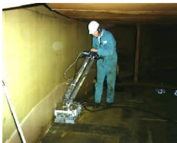
Obr. 16 – Měření tloušky na potrubí – měřící vozík.
