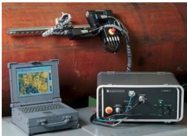
Obr. 20 – Schéma měření a mapování koroze dna nádrže v petrochemickém průmyslu.
