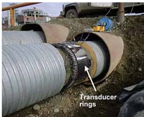
Obr. 10 - Příklad měření pomocí „Guided Waves“ na potrubí
