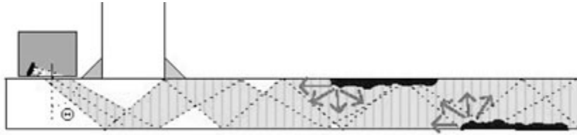
Obr.12 –Schematické zobrazení použití metodiky LORUS na dnech nádrží
