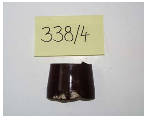
Obr. 8 – Začínajúci lupienkový lom č.263 a lokálne vylúpenie konca č.338/4
