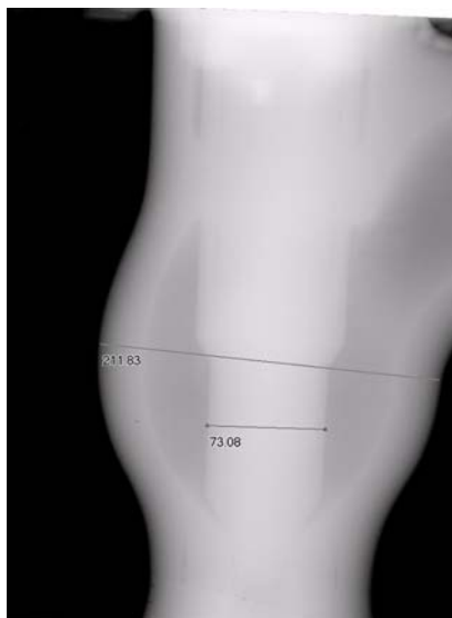
Obr. 13 – Záznam na IP platni s rozlíšením 100 \mu\text{m} a na odliatku, následné meranie vnútorných rozmerov častí dielov
